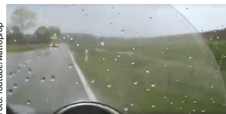
Foto oben: Propeller und Scheibe stehen. Unten: Die Drehung schleudert das Wasser ab, nur hinter der Scheibe bleiben Tropfen
